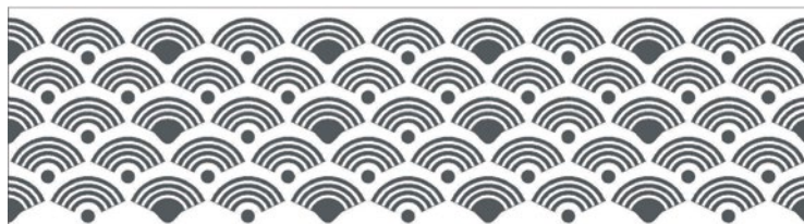
50mm孔洞间隔规律排布（该方案视觉效果较为有韵律感，灯位均匀布置，加工、施工难度小，但定制灯具的难度较大。）
