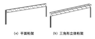
图6 桁架形式示意图
