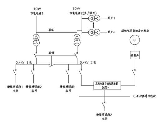
图3 低压供电方案图一
