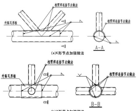
(b)X形节点加强做法 图10 桁架节点承载力加强措施
