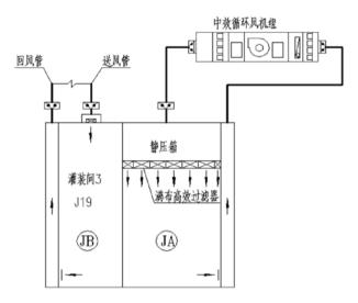
图7百级洁净区吊装循环机组+满布高效风口
