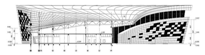
图3 热身池单元建筑剖面图
