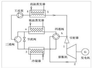
图1 使用纯工质的内置热泵CCHP-ORC系统
