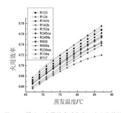
图6 CHP模式下火用效率随蒸发温度变化趋势
