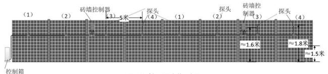
图4 墙砖探测器安装示意图
