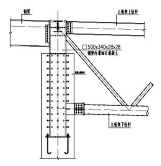
图11 支座节点做法示意图一
