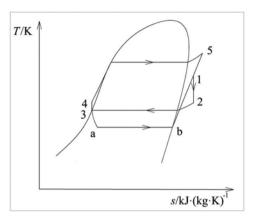
a 干工质系统流程T-s图
