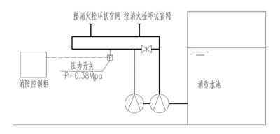
图2 消防水泵启动控制
