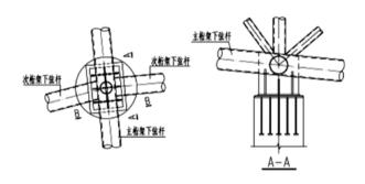
图12 支座节点做法示意图二
