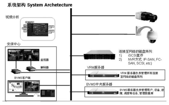
图6 安防视频监控系统框图
