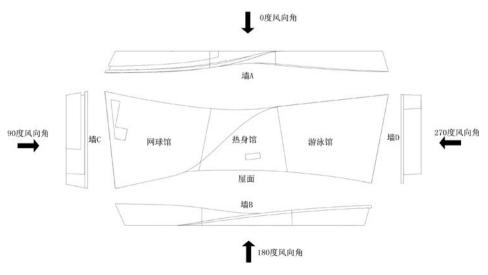
图4 风洞试验风向角定义
