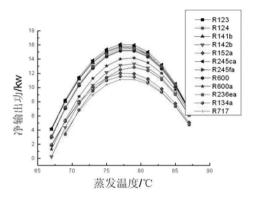
图3 CHP模式下净输出功随蒸发温度变化趋势
