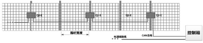
图3 围栏探测器安装示意图
