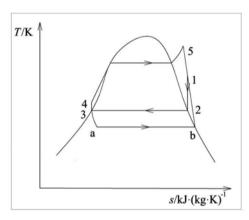
b 湿工质系统流程T-s图 图2 纯工质内置热泵CCHP-ORC系统热力学循环T-s图
