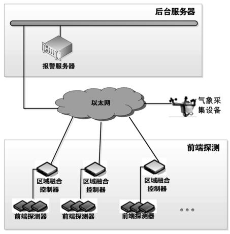
图2 MEMS振动入侵报警系统框图
