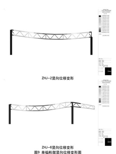
的关键部位,支座受力取中震弹性作用下的荷载组合。由于柱顶铰接,支座节点受竖向力、水平力以及水平力产生的附加弯矩作用。对于支座与混凝土柱的连接,无论采用锚栓还是锚筋连接方式,竖向压力起有利作用。此外,由于轻型屋盖自压力。此外,由于轻型屋盖自工程、风荷载工况下,大部分屋盖支座存在拉力的情况,最大支座拉力166kN。计算支座与混凝土柱的连接时,取水平力最大的荷载组合和拉力最大的荷载组合两种工况分别进行验算。对于存在拉力的混凝土柱,需进行裂缝验算,最大裂缝宽度限值0.2mm。
